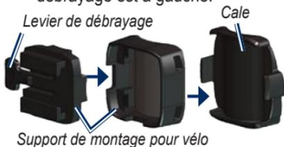
**Pour les tubes horizontaux :** retirez la partie supérieure du support, faites-la pivoter de 90 degrés, puis remettez-la en place. Passez à l'étape 2.
