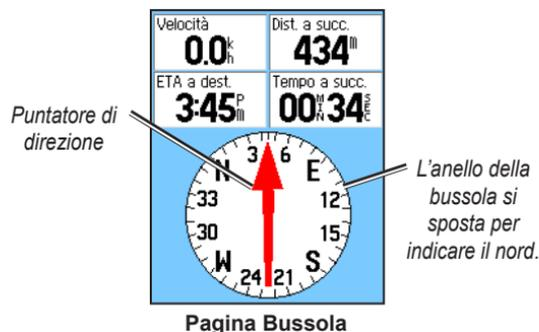
L'anello rotante della bussola indica la direzione della navigazione. Indicatori rilevamento e di rotta indicano la direzione da seguire per giungere a destinazione rispetto alla direzione di navigazione corrente. Scegliere un indicatore di rilevamento o di rotta come guida.
