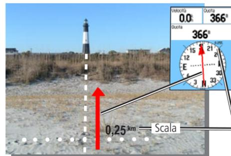
*L'indicatore di rotta indica l'itinerario del viaggio dalla posizione originale e la distanza percorsa lontano dalla rotta.*
