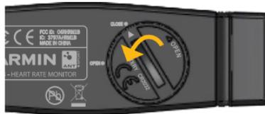
3. Rimuovere il coperchio e sostituire la batteria con il lato positivo rivolto verso l'alto.
