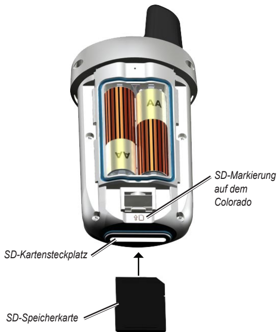
Einlegen einer SD-Speicherkarte in den Colorado
