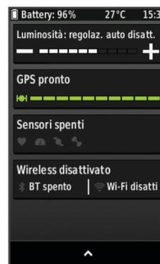
Viene visualizzata la pagina delle connessioni. Un'icona lampeggiante indica che il dispositivo sta effettuando una ricerca. Per modificare le impostazioni, selezionare un'icona.
