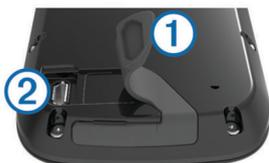
2 Inserire il connettore più piccolo del cavo USB nella porta USB del dispositivo.
