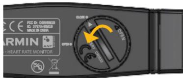
2. Aiutandosi con una moneta, ruotare il coperchio in senso antiorario finché la freccia non indica la posizione **OPEN**.
