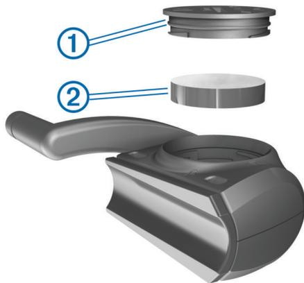
2 Utilizzare una moneta per far ruotare il coperchio in senso antiorario finché non viene allentato sufficientemente per essere rimosso (la freccia punta verso il simbolo di sblocco).
