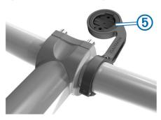
8 Drücken Sie den Edge leicht nach unten, und drehen Sie ihn im Uhrzeigersinn, bis das Gerät einrastet.
