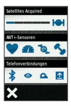
Die Statusseite der Sensoren und Verbindungen wird angezeigt. Wenn ein Symbol blinkt, führt das Gerät eine Suche durch. Sie können ein beliebiges Symbol auswählen, um die Einstellungen zu ändern.
