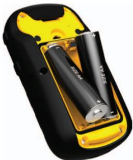
3. Remettez le cache du compartiment à piles en place et tournez l'anneau en D dans le sens des aiguilles d'une montre.
