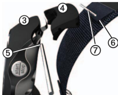
3. Insérez le côté pointu (5) de la barrette pour fixer le connecteur au Forerunner.
