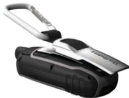
1. Placez le mousqueton avec clip dans les fentes de la rainure de fixation au dos de l'appareil.
