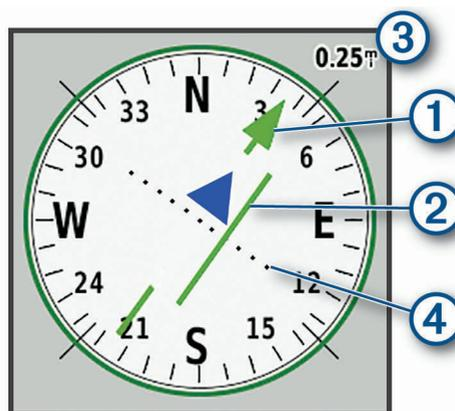
L'indicatore di percorso ① indica la posizione in relazione a una linea di percorso che conduce alla destinazione. L'indicatore di deviazione (CDI) ② fornisce l'indicazione di deviazione (destra o sinistra) dal percorso. La scala ③ si riferisce alla distanza tra i punti ④ sull'indicatore di deviazione, che indica la distanza dal percorso.
