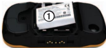
3. Allineare i contatti metallici sulla batteria a quelli presenti nel vano della batteria.
