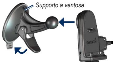
5. Inserire la base di appoggio sul braccio del supporto a ventosa, facendola scattare in posizione.
