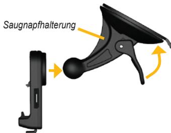
3. Reinigen und trocknen Sie die Windschutzscheibe mit einem fusselfreien Tuch. Entfernen Sie die Klarsichtfolie vom Saugnapf, und reinigen Sie diesen mit einem fusselfreien Tuch. Positionieren Sie die Saugnapfhalterung an der Windschutzscheibe.
