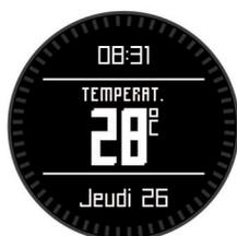
**REMARQUE** : la température de votre corps influe sur la lecture du capteur des températures. Pour obtenir un relevé des températures fiable, retirez l'appareil de votre poignet et attendez entre 20 et 30 minutes.
