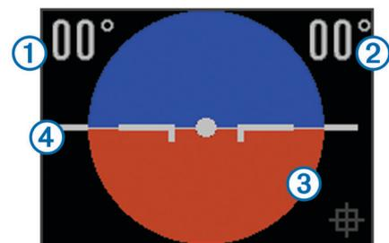
**2** Regolare il dispositivo finché il grado di rotazione ① e il grado di inclinazione ② sono entrambi impostati su 00° e la sezione marrone della bolla ③ si trova anch'essa sulla linea dell'orizzonte ④.
