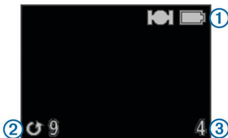
Il dispositivo esegue scatti di foto a ripetizione nell'intervallo selezionato. Il mirino visualizza lo stato del GPS e della batteria ①, il tempo in secondi allo scatto della foto successiva ② e il numero di ripetizioni di foto acquisite dal dispositivo ③.
