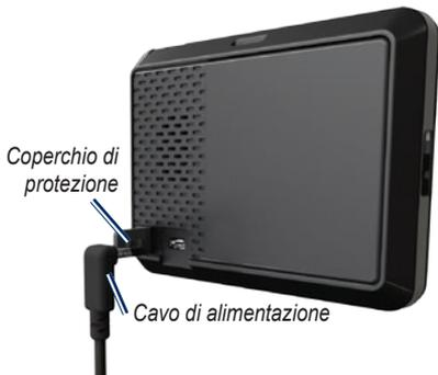
2. Inserire il cavo di alimentazione per autoveicoli nel connettore mini-USB.
